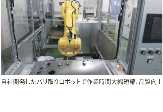
自社開発したバリ取りロボットで作業時間大幅短縮、品質向上
