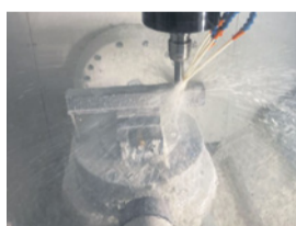
6パレット付き5軸マシニングセンタ。製品精度が向上した
