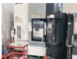
6パレット付き5軸マシニングセンタ。製品精度が向上した
